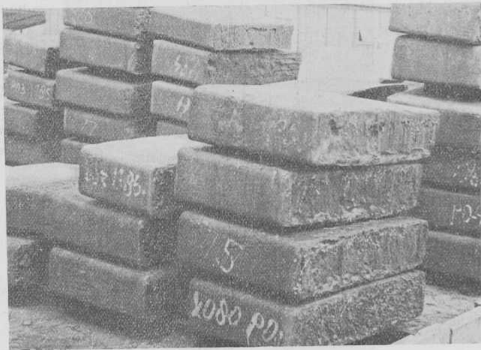
3 tons blokken voor dikke plaat walserij. foto K.N.H.S. N.V.
