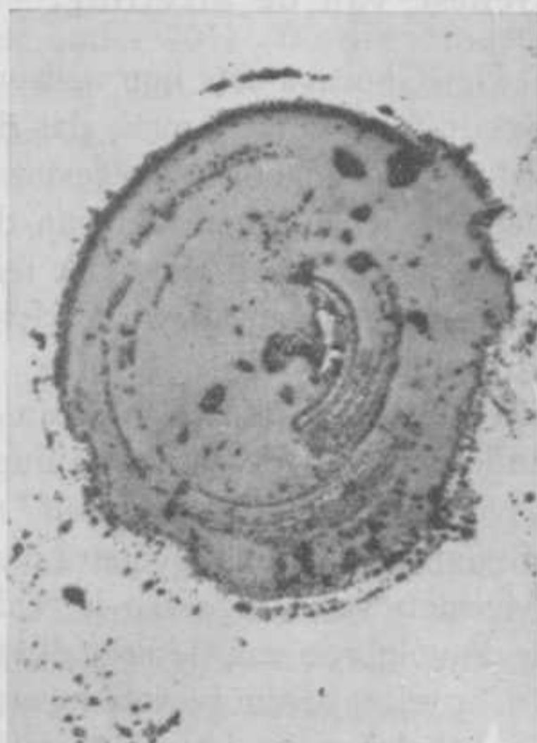
Afb. 6. Jamesoniet (grijs) vervangt een pyrietbolletje in pyriet (lichtgrijs). Vergrooting 250 \times . P.V.
