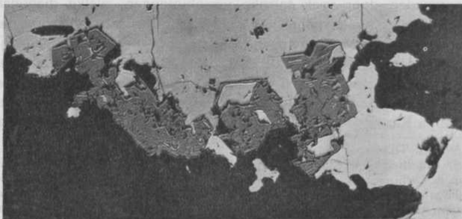
Foto 4. Klappa Kampit mijn, ader Rajah. Silikaatganggesteente (zwart), waarin een jongere combinatie van magnetiet (grijs) en pyrrhotien (wit) is binnengedrongen. De magnetiet, die door pyrrhotien vervangen wordt, doet zich voor als octaëdrische kristalskeletten. \times 190
