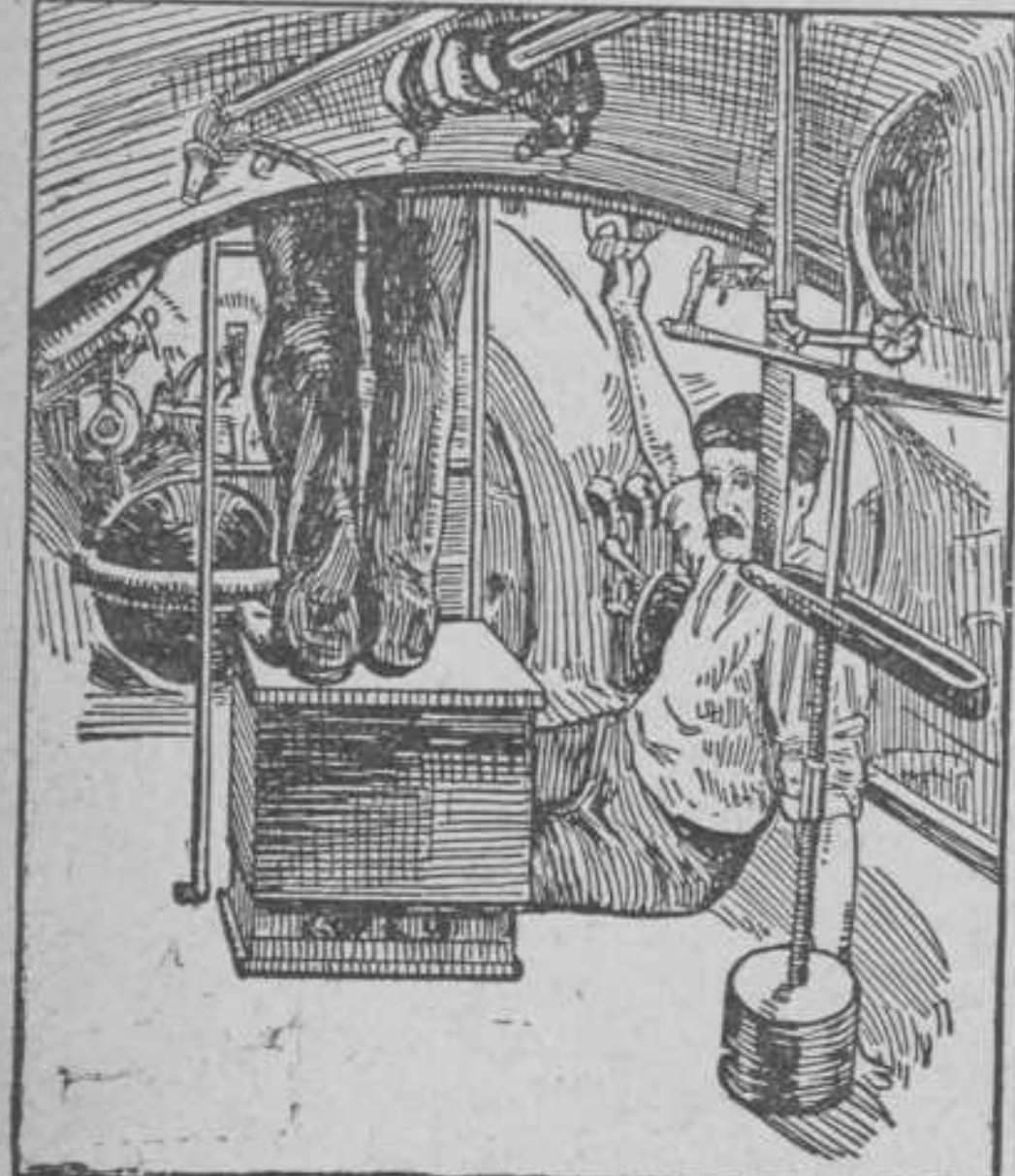
Machiniekamer en stuurstoel van de Amerik. onderzeeboot „Holland”. De groote slinger regelt de machinerie, die de boot op de verlangde diepte houdt.
