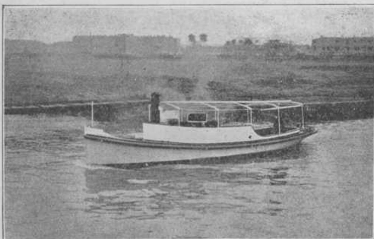
Fig. 20. Open kruiser 9,20 M. × 2,40 M. × 1,27 M.
