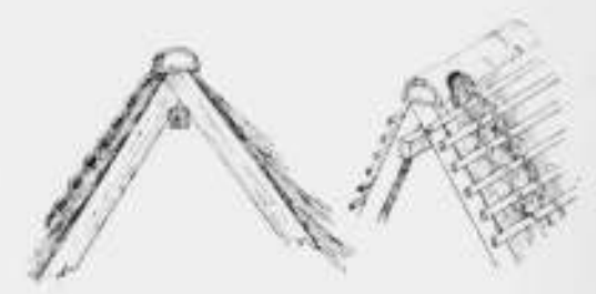
Fig. 9 Alang-alangdak met versterking van latwerk
