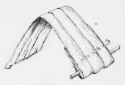
Fig. 3 Nebindleiding van atap
