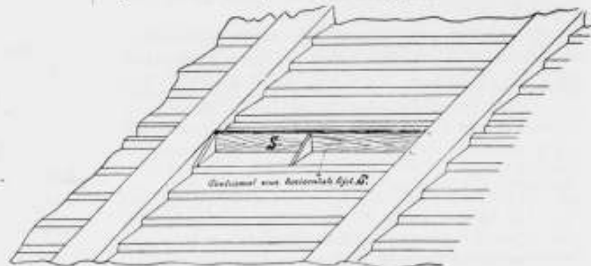
Fig. 7. Mal voor de horizontale lijst.
