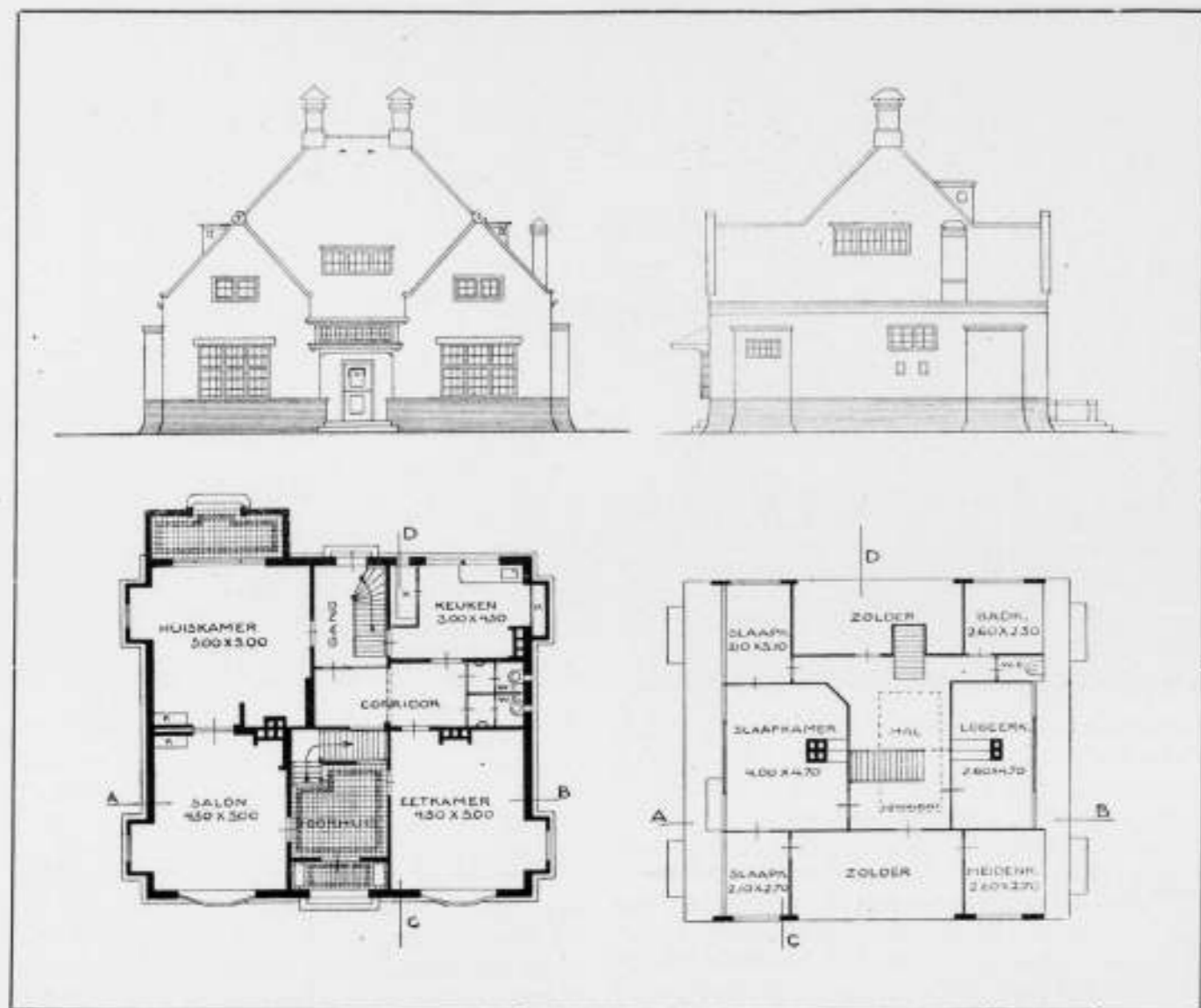
Tentoonstelling: „Huis en Tuin“, Modelwoning. Plan Begane grond en Verdieping. Voorgevel en Zijgevel. Schaal 1 op 200. Arch. L. ZWIERS.
