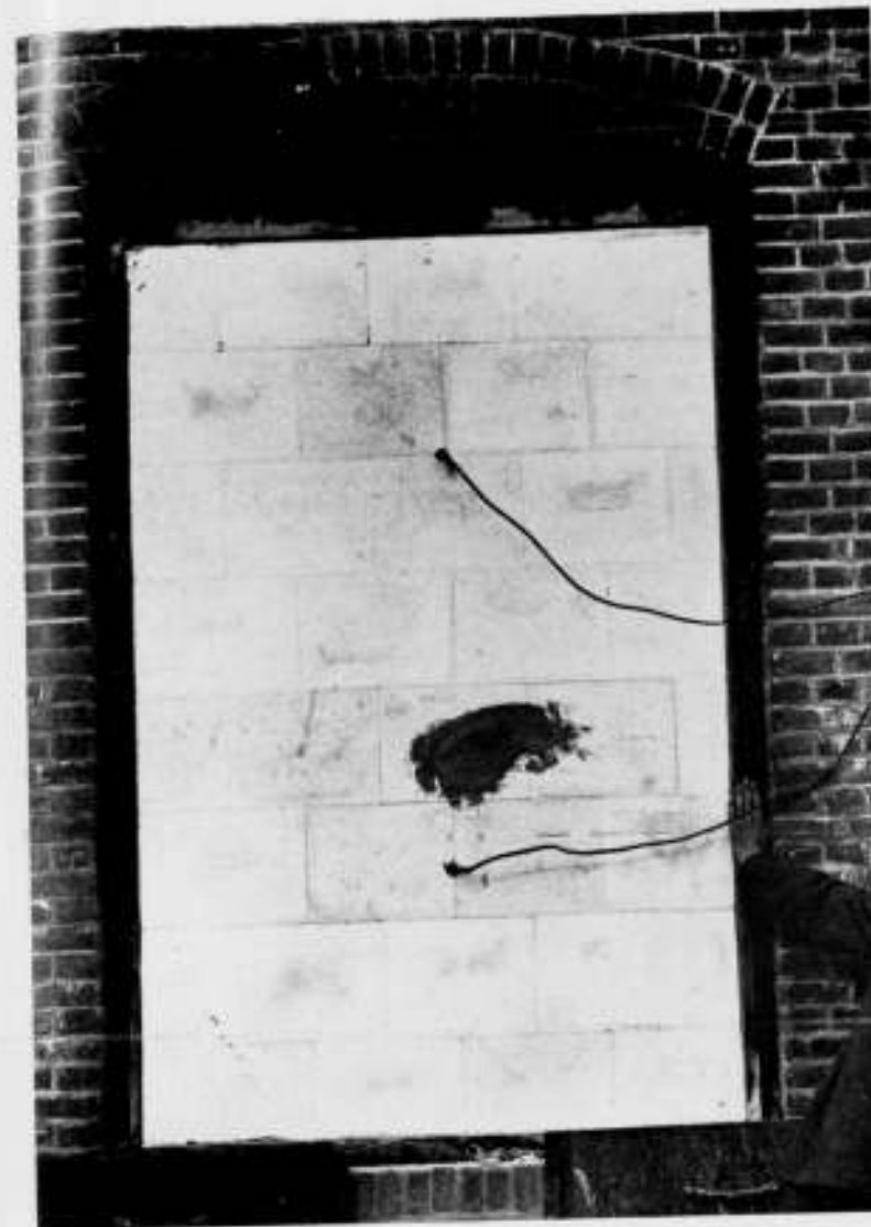
WAND VAN CELLENBETON VOÖR DE PROEF.
