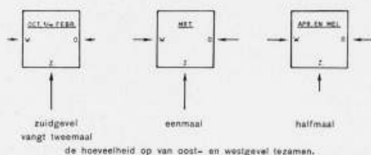
FIG. 13. VERHOUDING VAN DEN ZONNENSCIJN OP ZUID-, OOST- EN WESTGEVELS.
