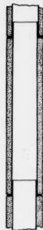
FIG. 47. GEISOLEERDE METALEN AFVOERPIJP.
