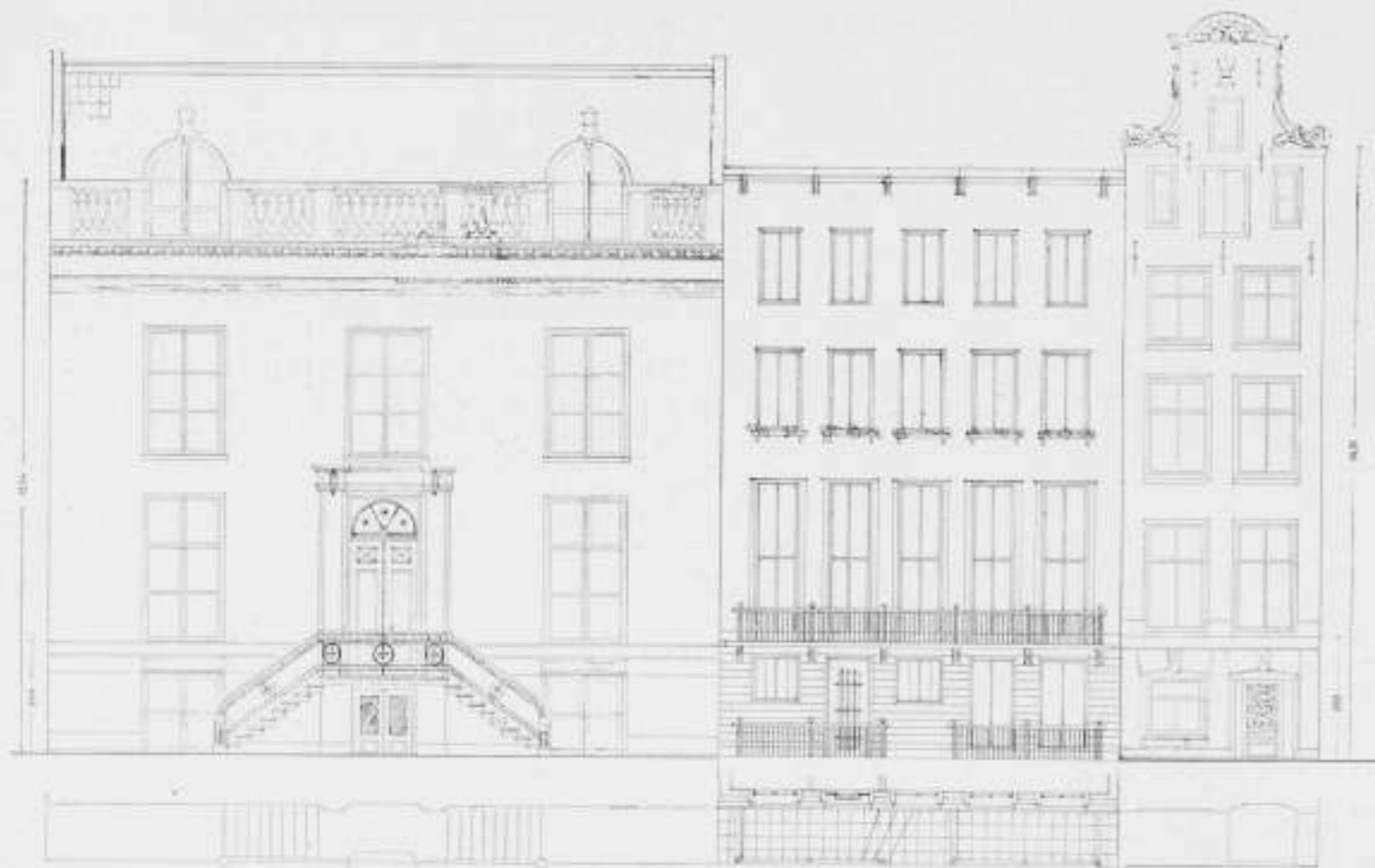
BAGEMENT EN GEPLAATDEKING DOCTERSHUIS ZANDSTEGEN, BALKEN EN LATHEN BOVEN HAREN OOR, BETON, GEVEL WARM DRUK VETSELDEREN, STALEN RAMEN IN HOUTEN KOZIJNEN, WIT EN CRÈME GESCHILDERD, HEEMSTEDEN, BRONS.
