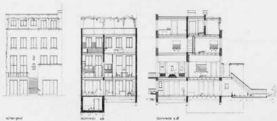
BAGEMENT EN GEPLAATDEKING DOCTERSHUIS ZANDSTEGEN, BALKEN EN LATHEN BOVEN HAREN OOR, BETON, GEVEL WARM DRUK VETSELDEREN, STALEN RAMEN IN HOUTEN KOZIJNEN, WIT EN CRÈME GESCHILDERD, HEEMSTEDEN, BRONS.
