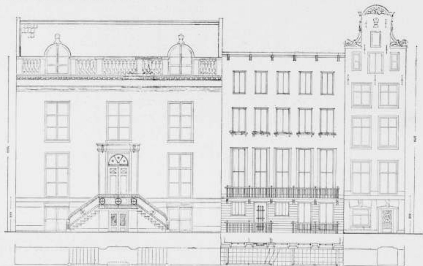
BAKENENT EN ZEVELAFDERINGS DOKTERSHUIS ZANDSTEEN. BALCON EN LAFEL ROVER RAMEN GEM. BETON. DEVEL WARM BRUIN METSELMERK. STALen RAMEN IN HOUTEN KOELEN. MET EN CREME GESCHILDERD. MEKWERK BRONS.
