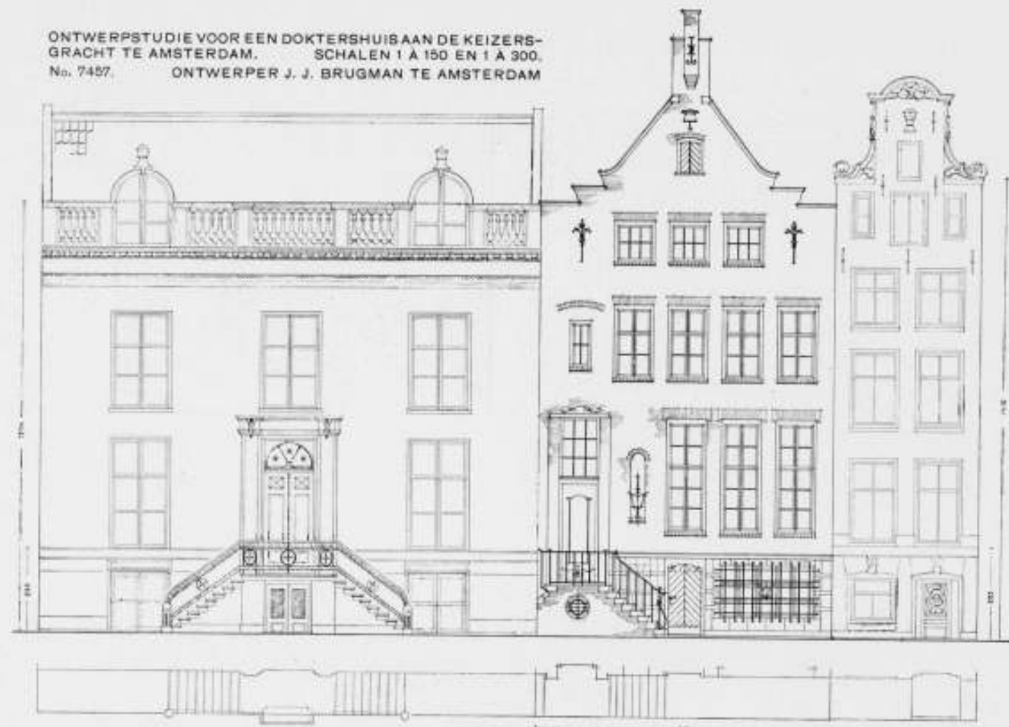
STOEP EN PLINT ETC. BEYERSCH GRANIET, VERDER NATUURSTEEN; BENTHEIMER ZANDSTEEN. METSELWERK: ROOD-BRUIJN DRIELINGEN FORMAAT. KOZIJNEN: CREME-RAMEN GEBROKEN WIT, VOORDEUR EIKEN GEROOKT, IJZERWERK DONKERGROEN
