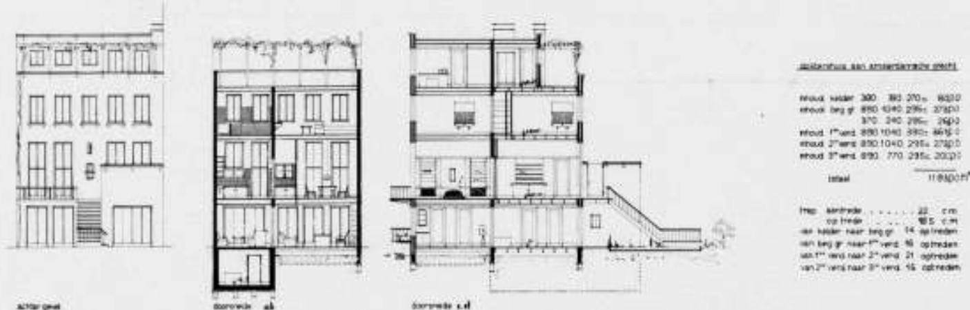
BAKENENT EN ZEVELAFDERINGS DOKTERSHUIS ZANDSTEEN. BALCON EN LAFEL ROVER RAMEN GEM. BETON. DEVEL WARM BRUIN METSELMERK. STALen RAMEN IN HOUTEN KOELEN. MET EN CREME GESCHILDERD. MEKWERK BRONS.
