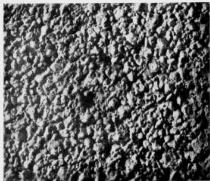
FIG. 7. OPPERVLAK VAN DE AMERIKAANSCH ACOUSTISCHE PLEISTER „INSULCRETE", OP WARE GROOTTE.
