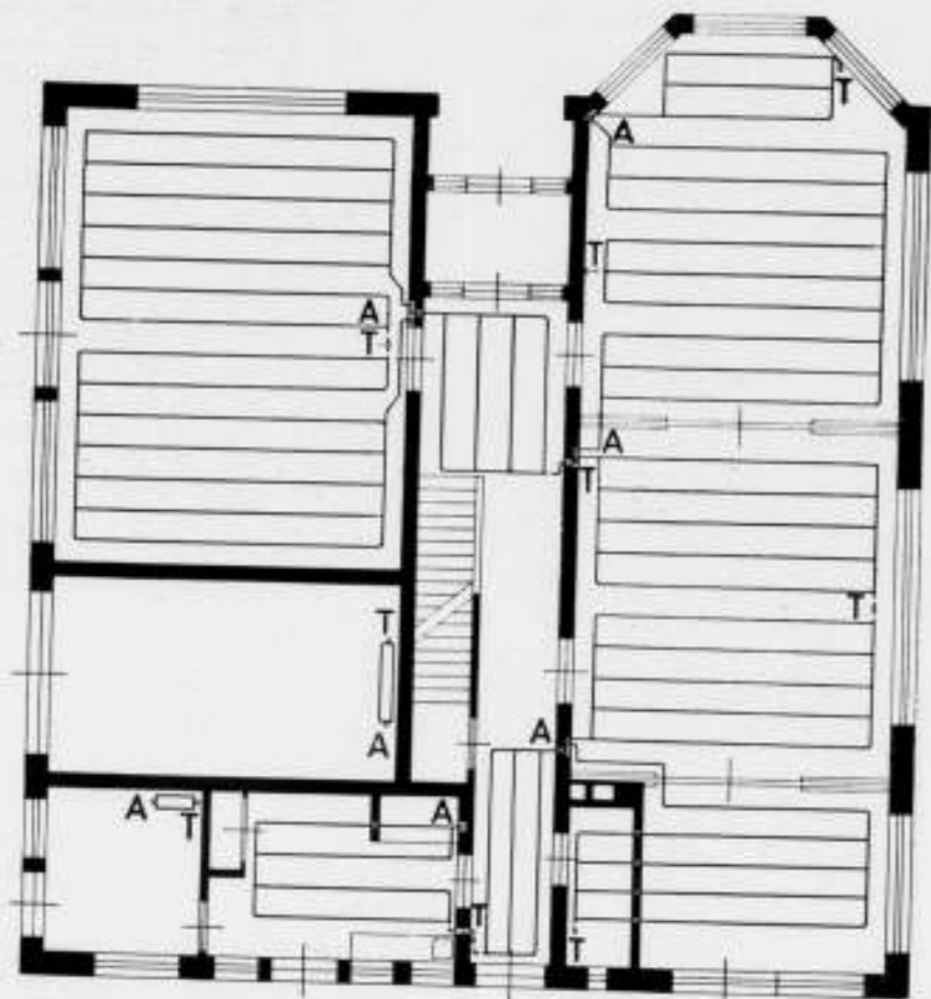
FIG. 7. A = Aanvoerleiding. T = Terugvoerleiding.
