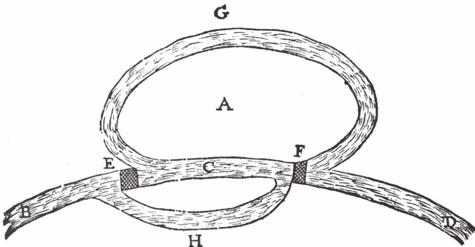
Men sal graven van E over G naer F, en van E over H naer F, en leggen een dam aen de bovesyde der Stadt tot E, en een ande laege zyde als F; en so salt water lopen den wech B H F C E G F D. Hier en fal sonder twijftel geen schuering gebreken, gemerct al het water daer deur moet.
