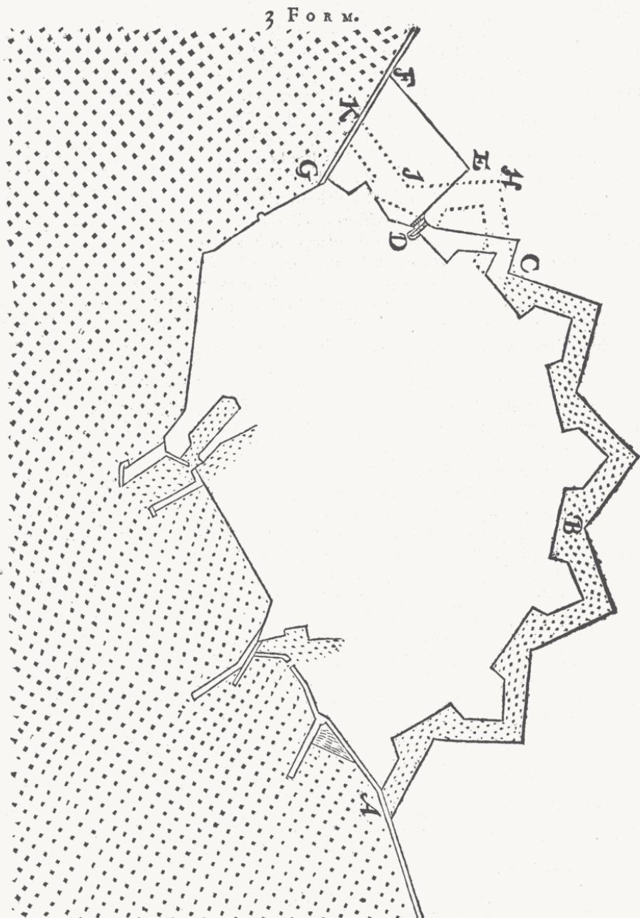
Maer alst daer toe quaem, en datmen schuerende Spillsluysen, wilde te werc stelen, zoo zoudemen de drie Beeren by A G D, der 3 Form moghen uytgraven, en legghen twee Spillsluysen aen L en M, als inde volghende 4 Form, doende het Molenwater D E F G te niet, malende na de manier verklært int 4 Voorbeelt des 3 Hooftstucx. En zoomen de Schepen inde gracht niet en wilde laten, maer binnen de Stadt doen ligghen, dat konde gheschieden met een inkomst door den
